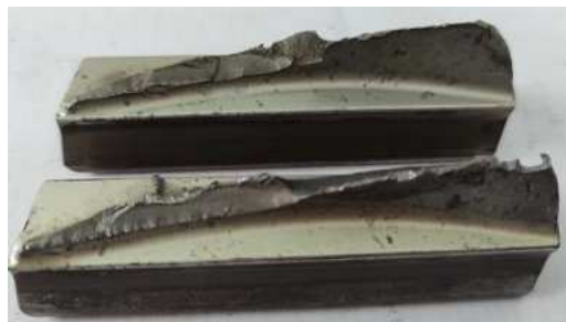
Figura 2: En la cara de fractura se muestran dos planos, uno normal al eje del álabe y el otro inclinado en aproximadamente 45°
