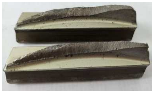
Figura 1: Caras de fractura con rotura en un plano de 45°
